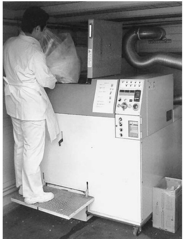
図6 乾熱滅菌粉砕装置(サニクラッシュ60型)
