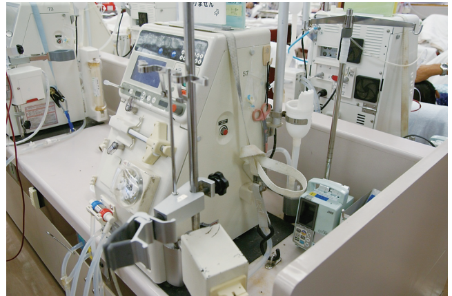
図8 カウンター設置型患者監視装置の固定 ベルト固定+台座に硬性のゴムマット。東日本大震災を乗り越える。カウンター設置型機械は転落なし。
