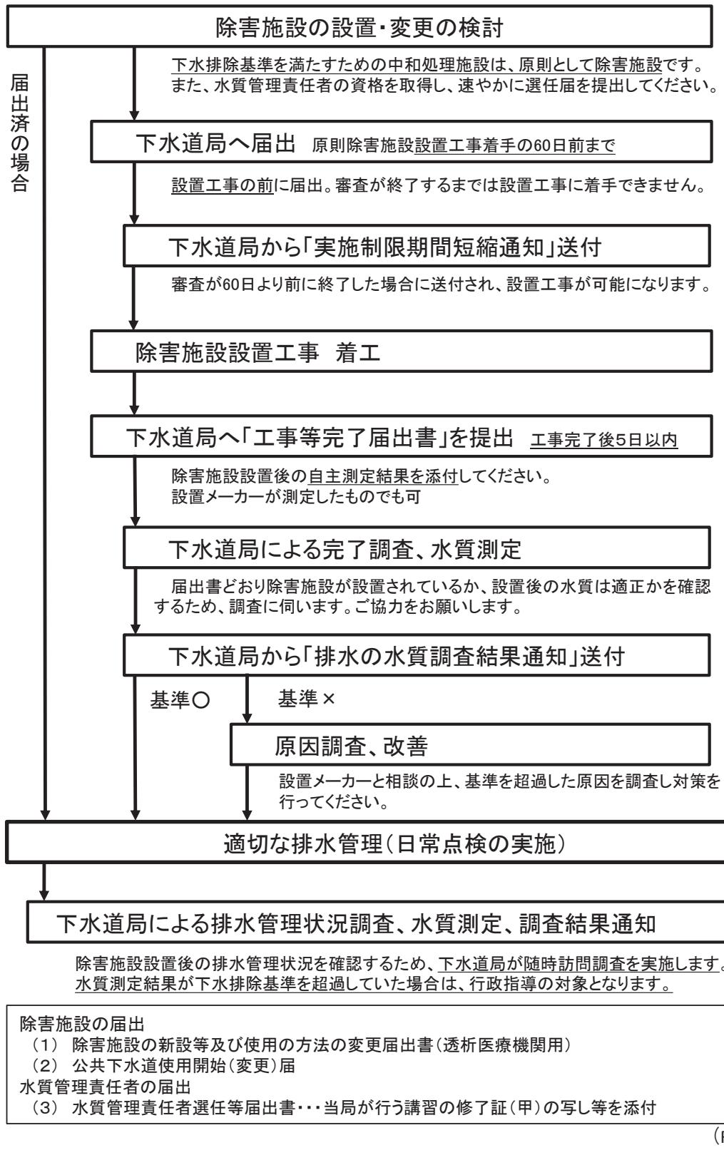
図1 透析医療機関向けの除害施設の新設・変更の流れ（東京都下水道局）
