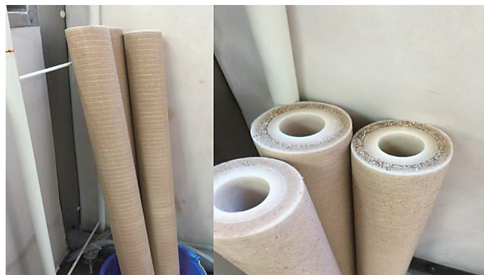
図 2 熊本地震において数日の汚濁水の通過で変色したフィルター (文献 88 より)
